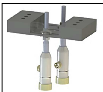
سیستم اندازه‌گیری ترک: پروب‌های تفاضلی جریان گردابی
