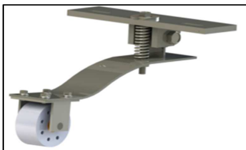
سیستم اندازه‌گیری مسافت: چرخ پنجم (مجموعه مولتی‌مگنت و سنسور هال)
