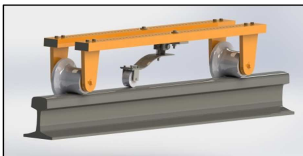
سیستم اندازه‌گیری مسافت: چرخ پنجم (مجموعه مولتی‌مگنت و سنسور هال)
